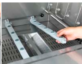
Установите на место нижние и верхние моечные рукава
