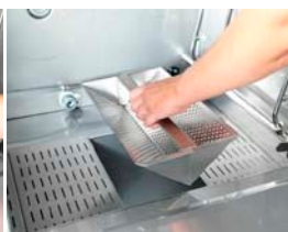
Выньте ситовую кассету и сетчатые фильтры
