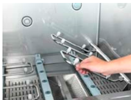
Откиньте вверх нижние трубопроводы ополаскивания
