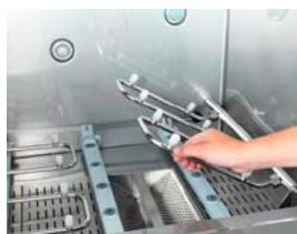
Откиньте вверх нижние трубопроводы ополаскивания
