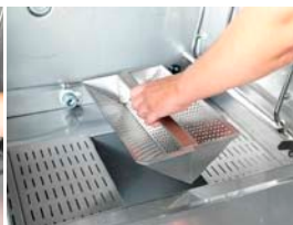
Выньте ситовую кассету и сетчатые фильтры
