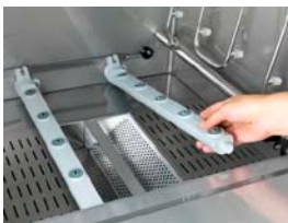
Снимите нижние и верхние моечные рукава
