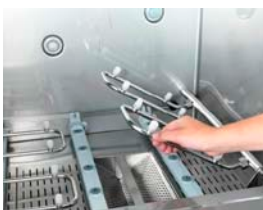
Откиньте вниз нижние трубопроводы ополаскивания
