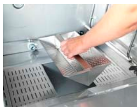
Вставьте ситовую кассету и сетчатые фильтры
